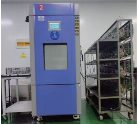
图6 环境温度与风速干扰实验装置图
