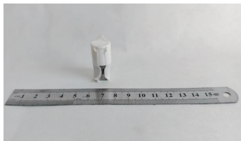
图4 不含雷管的装药结构图
