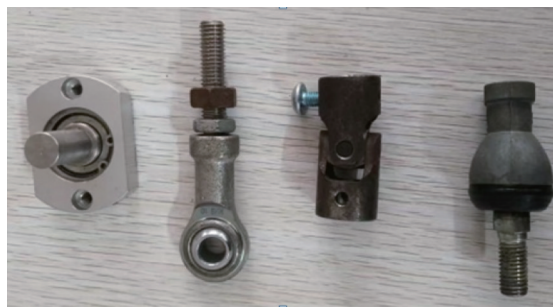
图1 部分机器人散件运动副
