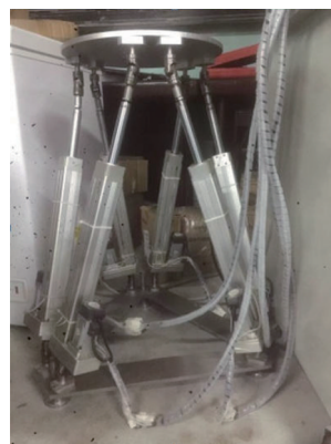
图 2 6-SPS 并联机器人实验系统
